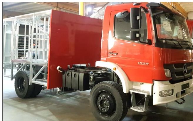
09/2017: Hochzeit von Kofferaufbau und Fahrgestell
